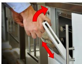
Per pulire la parte interna dei vetri, allentare le 3 viti nella parte inferiore della porta. Ora sfilare la parte interna della porta da quella esterna. Una volta separate le due parti procedere con la pulizia.
